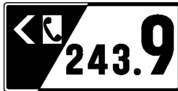
01b—Demarcação hectométrica da via – IC
