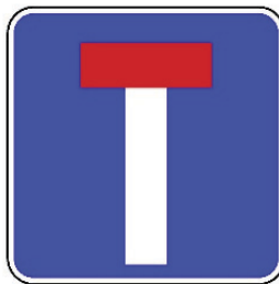
H4—Via pública sem saída
