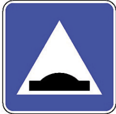
H48—Lomba redutora de velocidade
